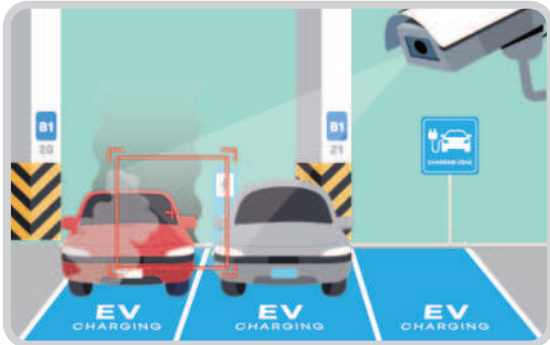
① CCTV 등을 통해 전기차 화재 상황을 확인한다. (차종, 화재위치 등)
