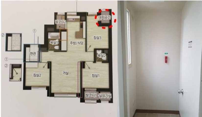
〈대피공간 방화문 설치〉
