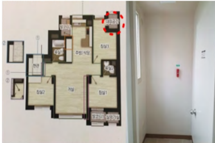
<대피공간 방화문 설치 >
