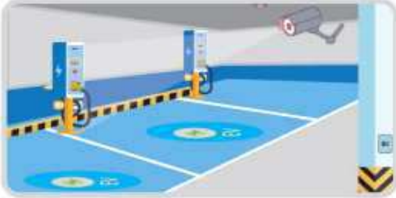
② CCTV(열화상 CCTV)는 전기차 충전구역을 비추는 전용 설치를 권장한다.
