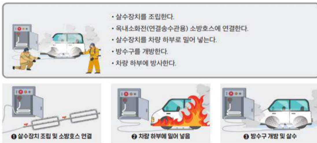
<그림 16> 상방향 살수장치 사용요령
