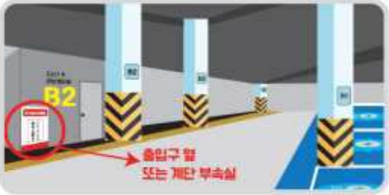
① 질식소화포, 상방향 살수장치는 출입구 옆에 두거나 계단 부속실에 보관한다.
